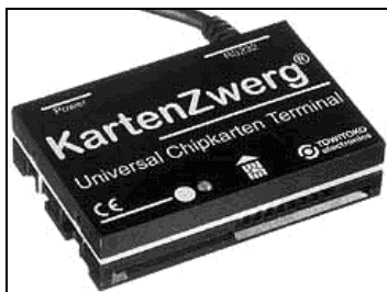
Abbildung: Verwendetes Schreib/Lesegerät (Foto: Towitoko electronics GmbH)
